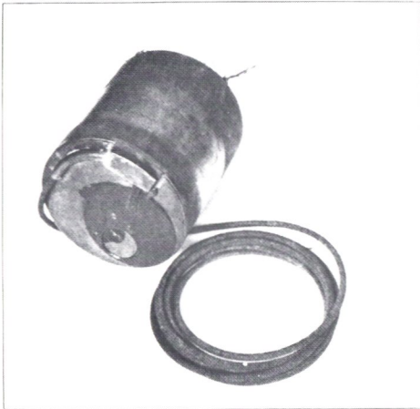
Bild 59. kameran finns fortfarande bevarad och på bilden ser man tids-stubinen som löper fram till slutarskivan.
